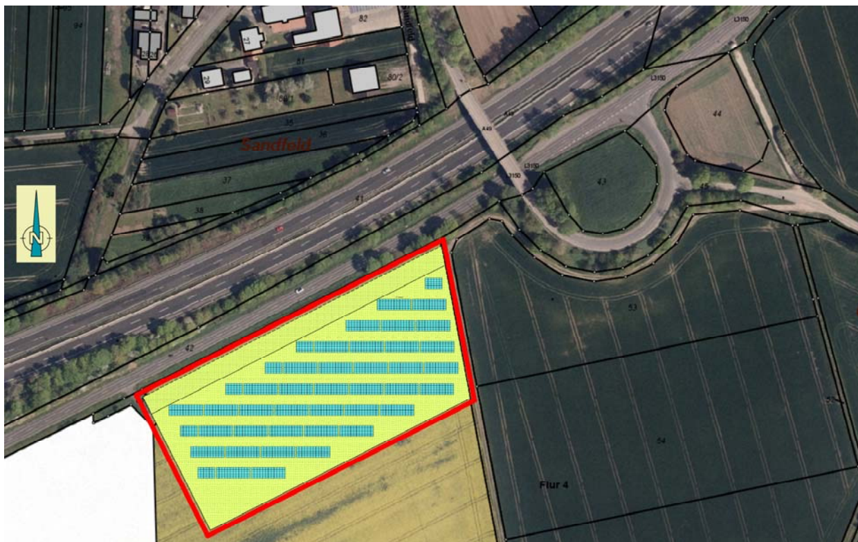
Skizze zur Anordnung der Modulreihen
