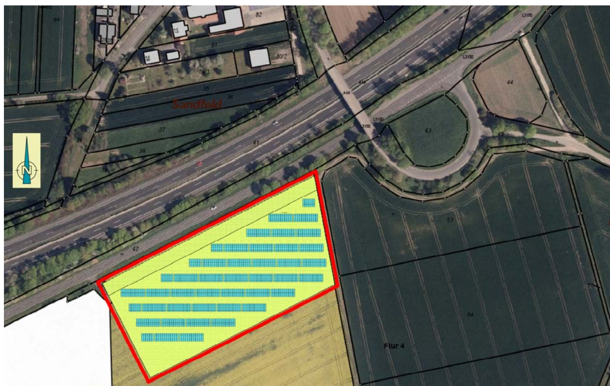
Skizze zur Anordnung der Modulreihen
