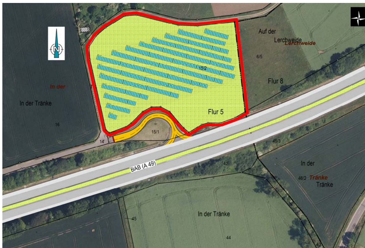
Skizze zur Anordnung der Modulreihen
