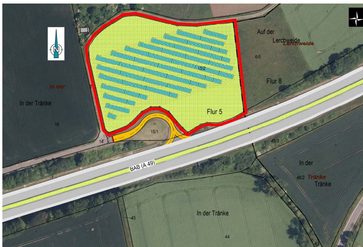
Skizze zur Anordnung der Modulreihen
